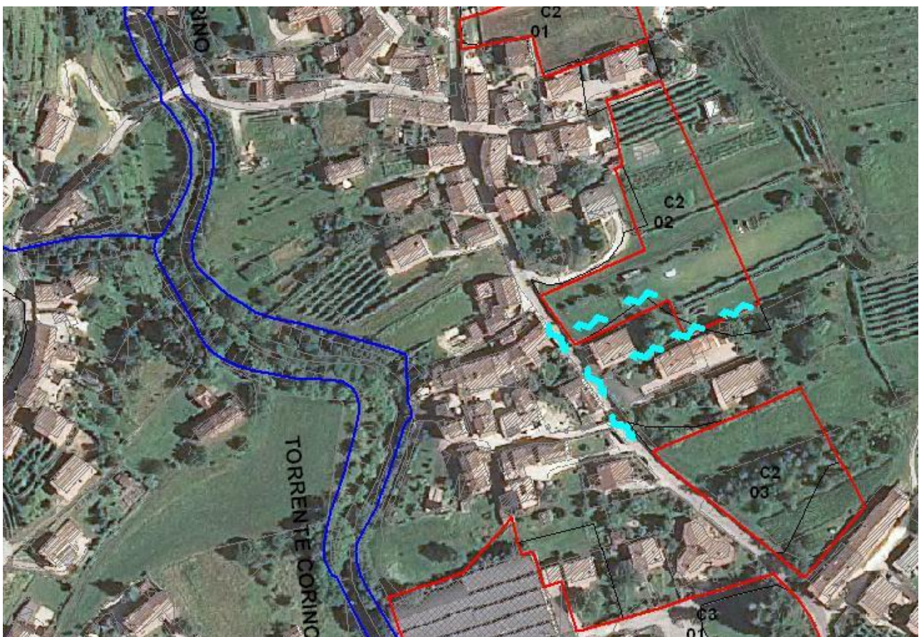
Figura percorso meteoriche: indicati in giallo la rete meteorica individuata, in blu i principali collettori, con le frecce in ciano il possibile percorso delle meteoriche
