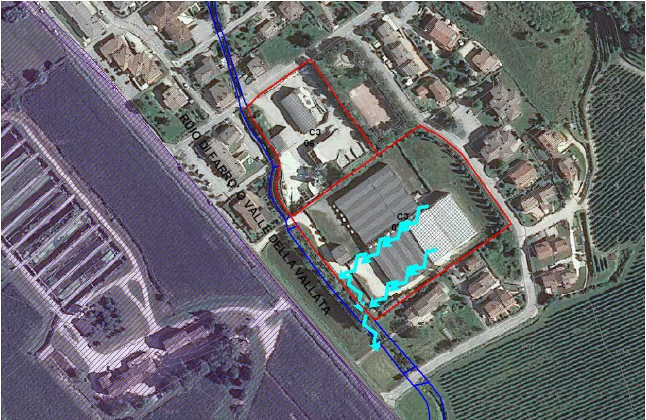
Figura percorso meteoriche: indicati in giallo la rete meteorica individuata, in blu i principali collettori, con le frecce in ciano il possibile percorso delle meteoriche
